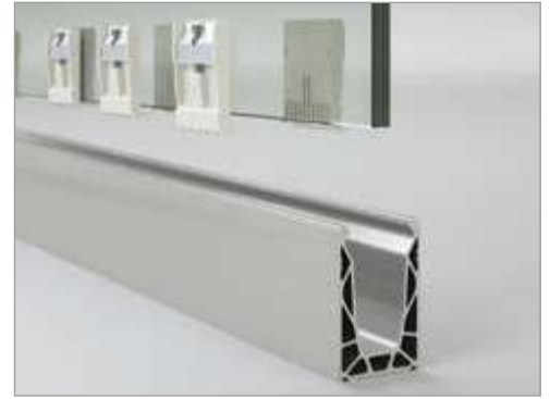
2 Assemblage pince, entraxe des pinces sur le verre 250 mm - 4 pinces/m
