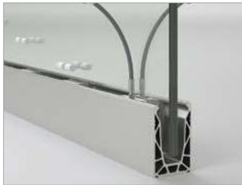
4 Introduction des rouleaux en POM. Les rouleaux garantissent la meilleure distribution de la charge sur l'interface verre/pince/profil, en maximisant la performance du système. Réglage et serrage avec visseuse. Couple de serrage 3 Nm
