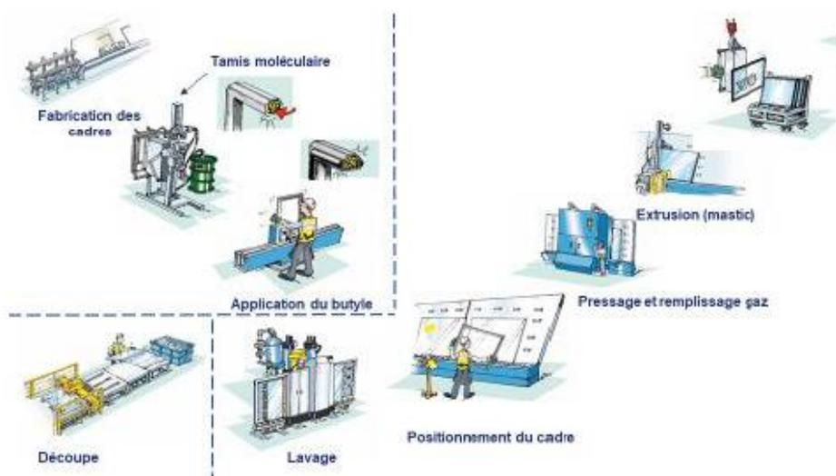
2. **PRODUCTION DES COMPOSANTS** : En parallèle le spacer est préparé. Il arrive sur la ligne sous forme de barre de plusieurs mètres de long. Cette barre est pliée jusqu'à l'obtention du cadre de la dimension du vitrage. Le cadre est rempli de tamis moléculaire (agent desséchant) puis fermé manuellement par un connecteur. Le cadre passe ensuite entre deux injecteurs de mastic butyle qui recouvrent la totalité du bord.
