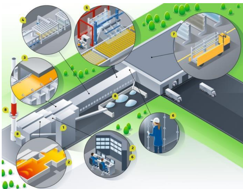
Figure 1 : Description de la ligne de production du verre clair PLANICLEAR® de 4mm selon le procédé float.
